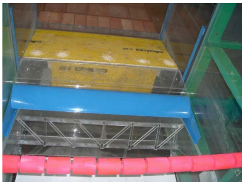
StrafloMatrix™ - Krafthaus in einer bestehenden Schleuse
